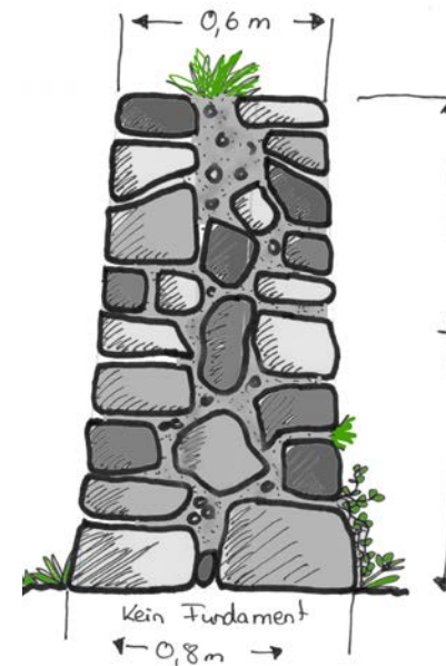
Trockenmauer als kleine Umfassungsmauer auf gesetztem Grund
